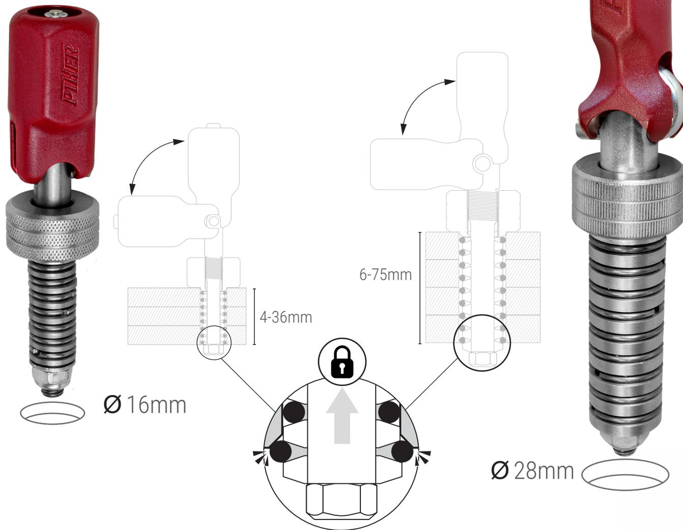
Système de blocage breveté grâce aux anneaux extensibles et cales.
